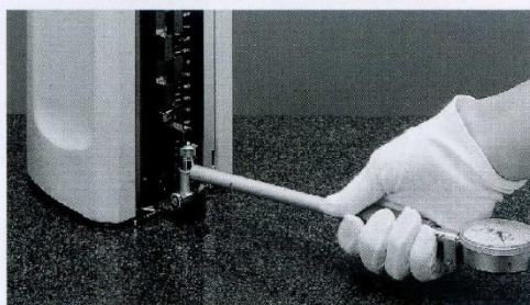
高度規搭配塊規歸零
