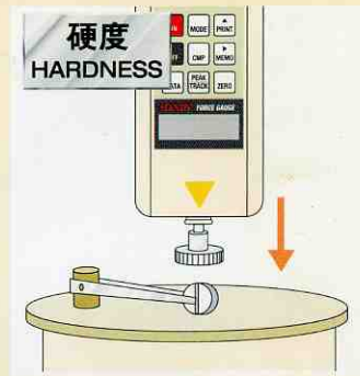
硬度測試：藥錠、水果、口紅、黏度的測試。
