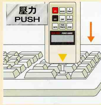
開關按鍵的操作力測定：電話、計算機、遙控器。
