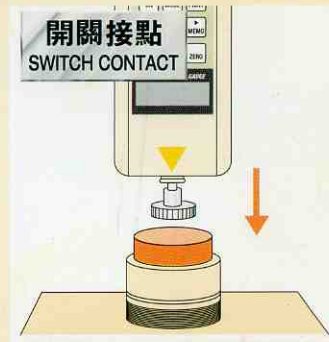
開關接點觸動力測試：機械式接點的觸動力測試。
